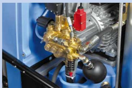
Le nouveau bloc de régulation conçu par **Kränzle** comprend un régulateur de pression permettant un réglage progressif du débit d'eau et de la pression ainsi qu'un fonctionnement en by-pass à pression réduite, une soupape de sûreté pour la protection de l'appareil contre les surpressions éventuelles au-delà des pressions admissibles, un contrôleur de débit pour couper l'alimentation du brûleur en cas de manque d'eau afin d'éviter une surchauffe de la chambre de combustion.
